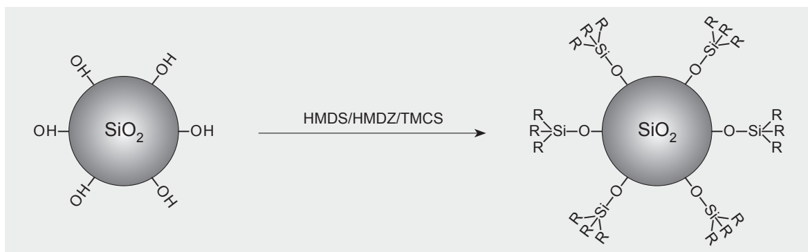
Slika 9: Sililiranje silicijevega gela [4] (HMDS – heksametildisilan, HMDZ – heksametildisiloksan, TMCS – trimetilklorosilan)
