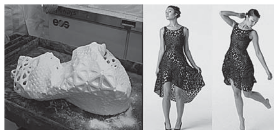
Slika 9: »Kinematična« oblačila podjetja Nervous System: zložena oblika zmanjša velikost modela za 85 odstotkov, kar omogoča tiskanje obleke v enem samem kosu [39]
