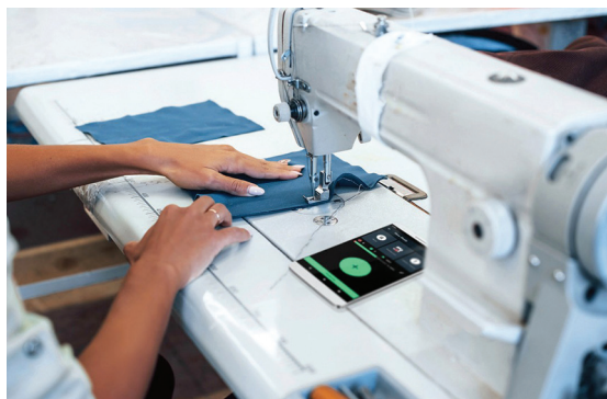
Slika 11: Mobilna aplikacija podjetja Artitex GmbH Time Study [20], zasnovana za spremljanje dela na šivalni delovni postaji
